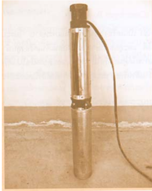
รูปที่ 31 เครื่องสูบน้ำบาดาลซับเมิซซิเบิล (Submersible Pump)
